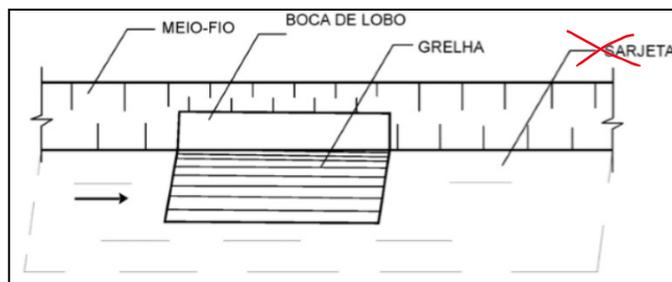
**Figura 2-XLVIII: Modelo 'combinado', dispositivo comum de coleta de águas pluviais dos logradouros em Palmas – fonte: DNIT, 2006<sup>6</sup>**
