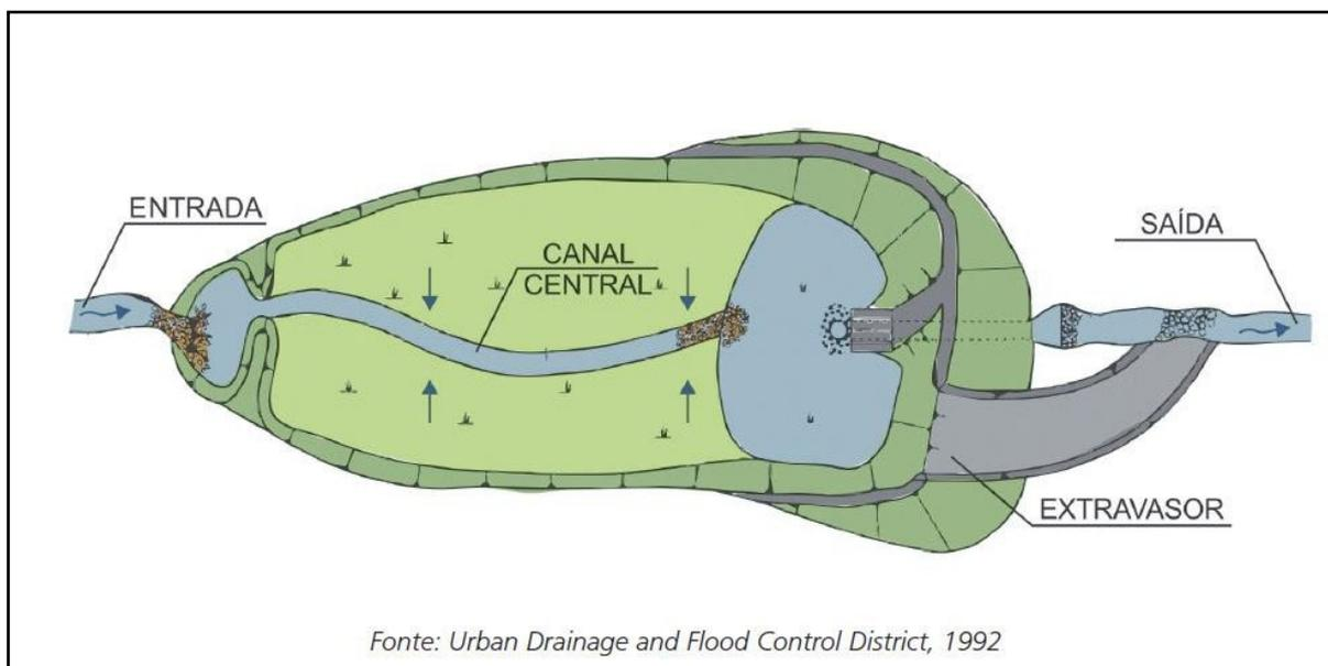
**Figura 3-X: Esquema-tipo de bacia de retenção seca**
