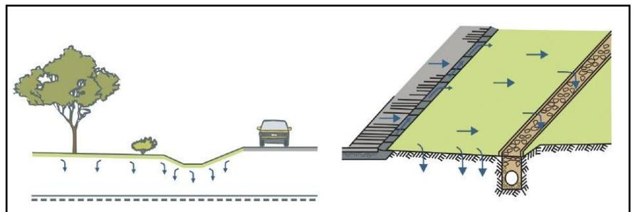
**Figura 3-XVII: Trincheira de Infiltração**
