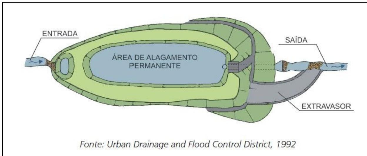
**Figura 3-XI: Esquema-tipo de bacia de retenção alagada**
