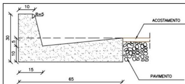
**Figura 2-XLVII: Seção-tipo de sarjeta em via pública – fonte: DNIT, 2006<sup>6</sup>**
